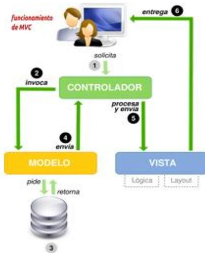
Fig. 5. modelo vista controlador (MVC) [7].
